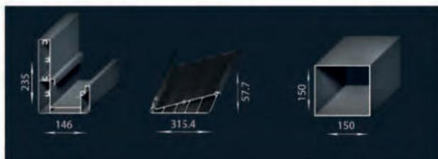
Der Skyroof Prestige ist mit vier Stützen und einem max. Ausfall von 5799 mm gefertigt. Bei einem größeren Ausfall muss pro Ausfallseite eine weitere Stütze hinzugefügt werden. Die Ausfallberechnung erfolgt im Abstand von 279 mm.
